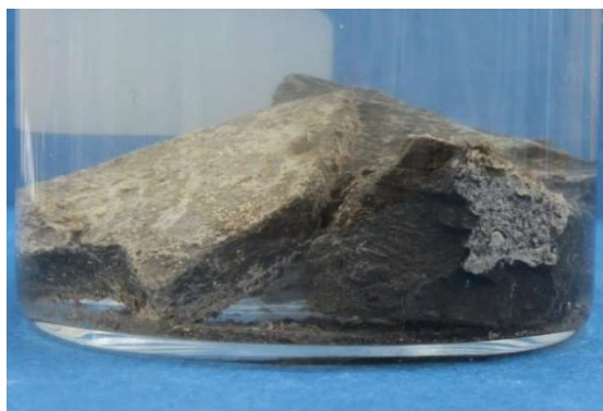
Fot. nr 58a. Próbka tuż po dodaniu roztworu KCl.
