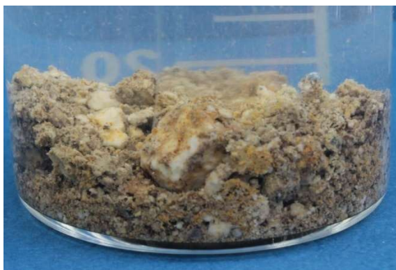
Fot. nr 13a. Próbkę po dodaniu roztworu KCl.
