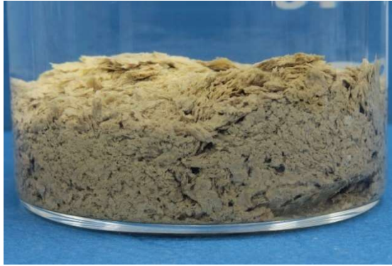
Fot. nr 25c. Granulki Compactonitu po zakończeniu testu, 7% roztwór KCl.
