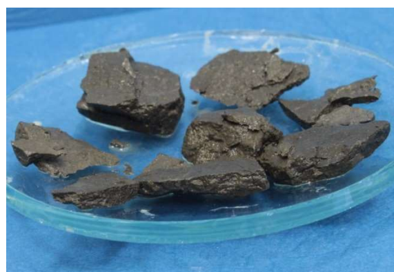
Fot. nr 60b. Próbką po wyjęciu z 7% roztworu KCl.
