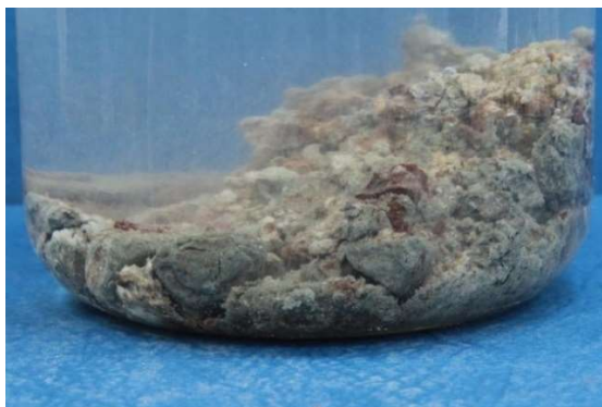
Fot. nr 80a. Próbkę tuż po dodaniu roztworu NaCl.
