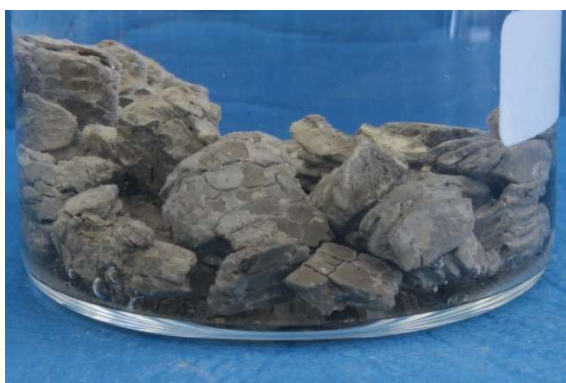
Fot. nr 46a. Próbka tuż po dodaniu roztworu KCl.
