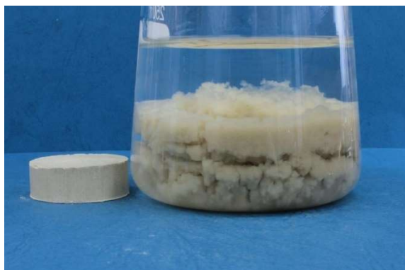
Fot. nr 27c. 24 godz. po dodaniu wody. Po lewej stronie dla porównania pastylka bentonitu użyta do testu.
