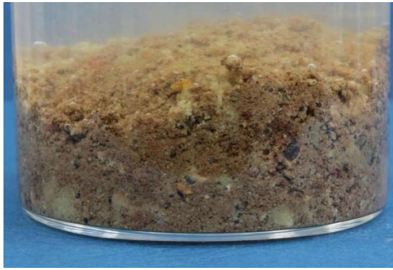
Fot. nr 17a. Próbka po dodaniu roztworu KCl.
