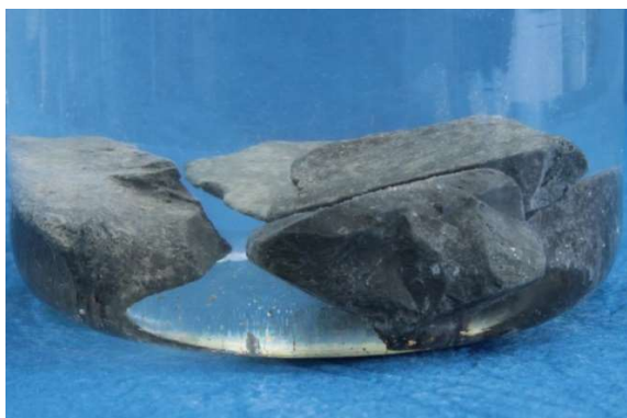
Fot. nr 92a. Próbka tuż po dodaniu roztworu NaCl.
