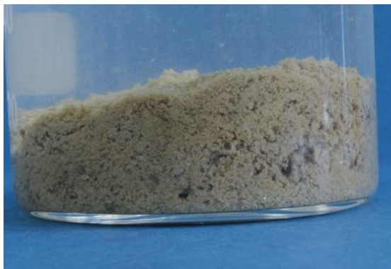
Fot. nr 9a. Próbkę po dodaniu roztworu KCl.
