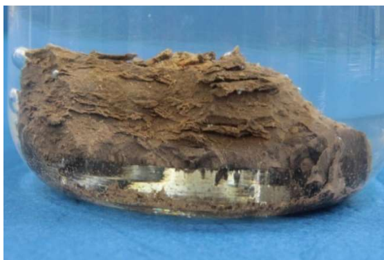
Fot. nr 54a. Próbka tuż po dodaniu roztworu KCl.
