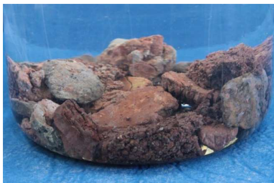
Fot. nr 68a. Próbkę tuż po dodaniu roztworu NaCl.
