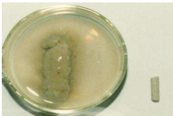
Fot. nr 1 Zachowanie pęczniące montmorylonitu. Po prawej stronie próbka łu w stanie suchym, po lewej próbka tej samej wielkości poddana działaniu wody.
