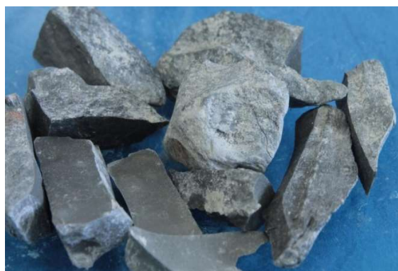
Fot. nr 93b. Próbka po wyjęciu z 7% roztworu KCl.
