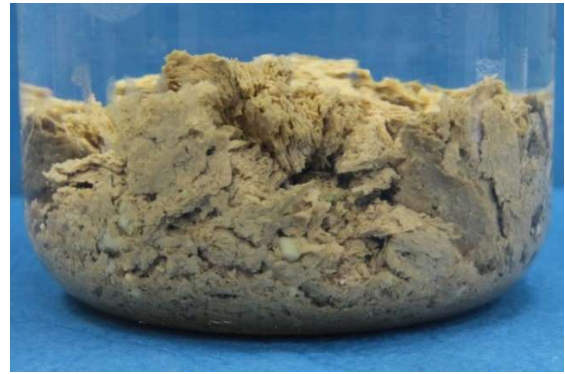
Fot. nr 26c. Granulki Compactonitu po zakończeniu testu, 26% roztwór NaCl.
