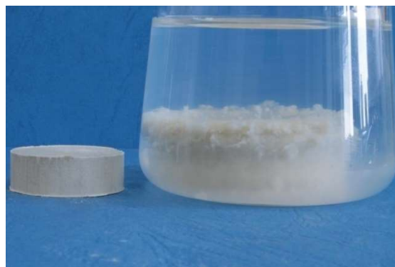
Fot. nr 27b. 4 godz. po dodaniu wody. Po lewej stronie dla porównania pastylka bentonitu użyta do testu.
