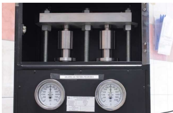
Fot. nr 6a. Prasa do przygotowania próbek.
