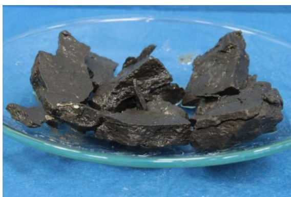
Fot. nr 60c. Próbką po wyjęciu z 26% roztworu NaCl
