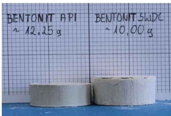
Fot. nr 31a. Porównanie objętości próbek bentonitów.
