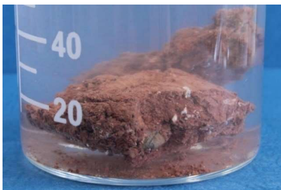
Fot. nr 87a. Próbkę tuż po dodaniu roztworu KCl.
