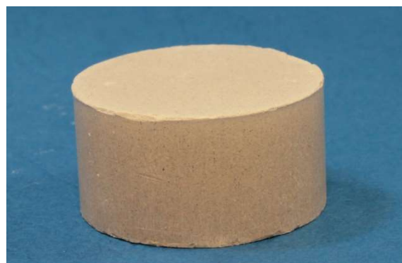
Fot. nr 6b. Próbką bentonitu po sprasowaniu..
