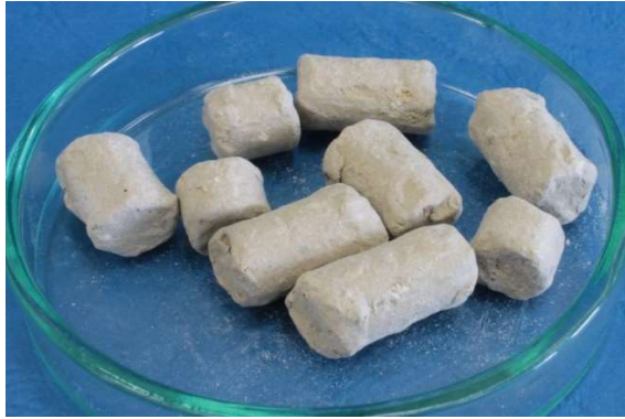
Fot. nr 23. Widok granulek bentonitu Compactonit 10/200 .
