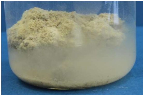
Fot. nr 8a. Próbkę ilitu po dodaniu wody.
