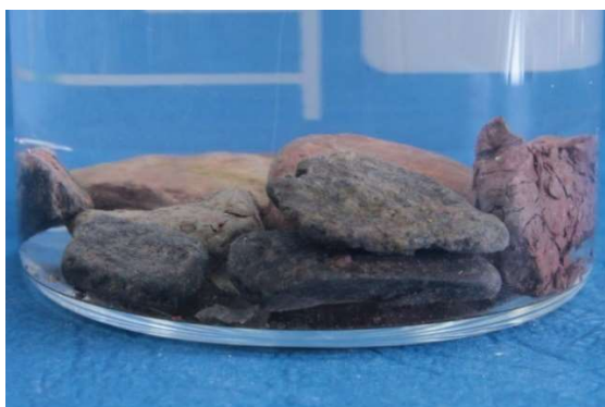
Fot. nr 71a. Próbką tuż po dodaniu roztworu KCl.
