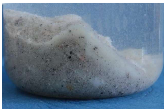
Fot. nr 22a. Próbką po dodaniu roztworu NaCl.
