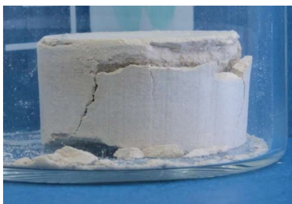
Fot. nr 30. Próbką Bentonitu SWDC po sprasowaniu, która uległa rozpadowi w trakcie wypychania z prasy.
