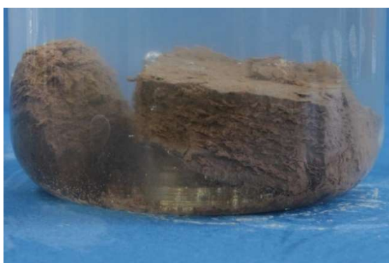
Fot. nr 55a. Próbka tuż po dodaniu roztworu NaCl.
