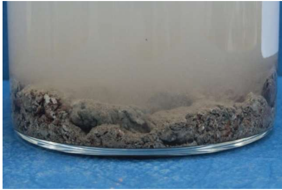
Fot. nr 79a. Próbkę tuż po dodaniu roztworu KCl.
