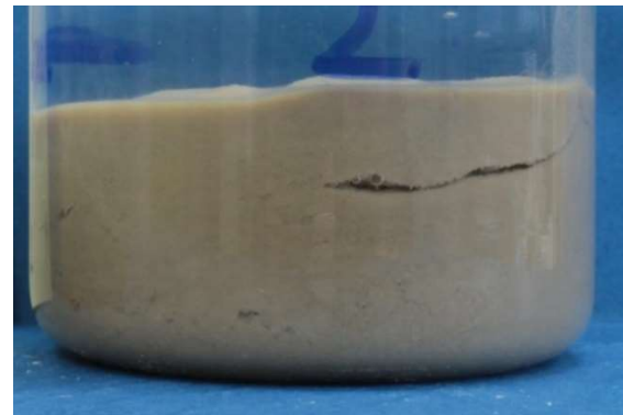
Fot. nr 35b. 4 godz. po dodaniu roztworu NaCl.
