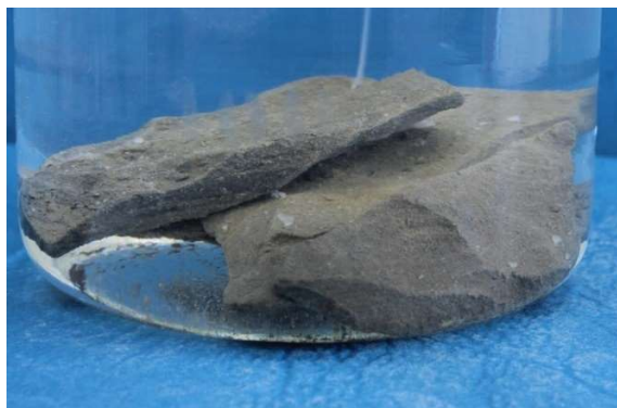
Fot. nr 43a. Próbka tuż po dodaniu roztworu NaCl.
