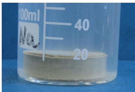
Fot. nr 29a. Pastyłka bentonitu tuż po roztworu NaCl.
