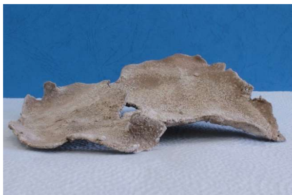
Fot. nr 98a. Fragment zdartego osadu filtracyjnego
