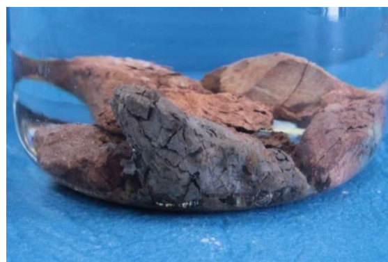
Fot. nr 76b. 4 godz. po dodaniu roztworu NaCl.
