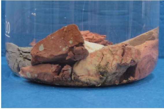
Fot. nr 63a. Próbkę tuż po dodaniu roztworu KCl.
