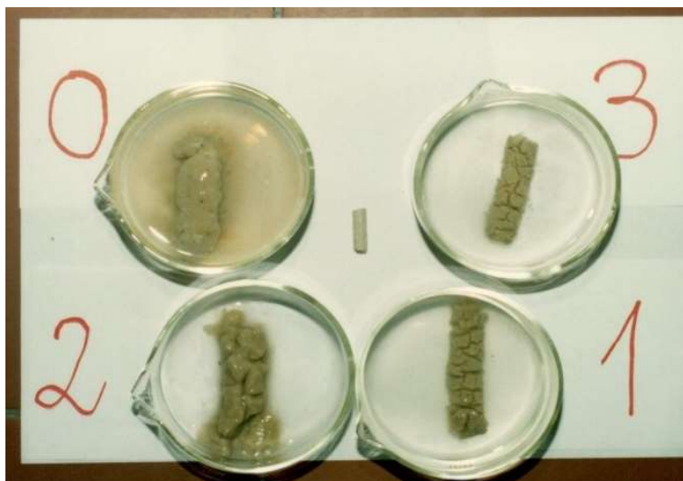
Fot. nr 5b. Wpływ roztworów różnych polimerów na komercyjny bentonit. Próbką (0), lewa górna – woda; próbka (2), lewa dolna – roztwór skrobi o stężeniu 1,5%; próbka (3), prawa górna – roztwór karboksymetylocelulozy o stężeniu 1,5%; próbka (1), prawa dolna – roztwór karboksymetyloskrobi o stężeniu 1,5%; pośrodku próbka bentonitu użytego do badań.
