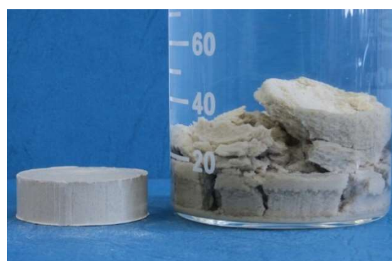
Fot. nr 29b. 4 godz. po dodaniu roztworu NaCl.
