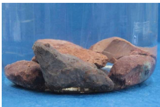
Fot. nr 76a. Próbka tuż po dodaniu roztworu NaCl.
