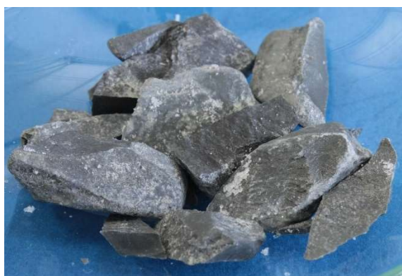
Fot. nr 93c. Próbka po wyjęciu z 26% roztworu NaCl.
