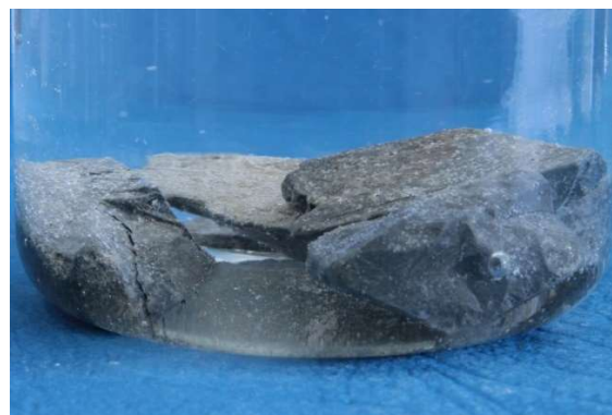
Fot. nr 92b. 4 godz. po dodaniu roztworu NaCl.
