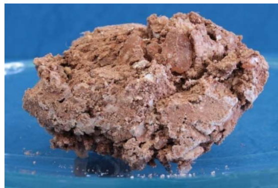
Fot. nr 85b. Próbkę czerwonego iłu solnego po wysuszeniu w 105 °C.
