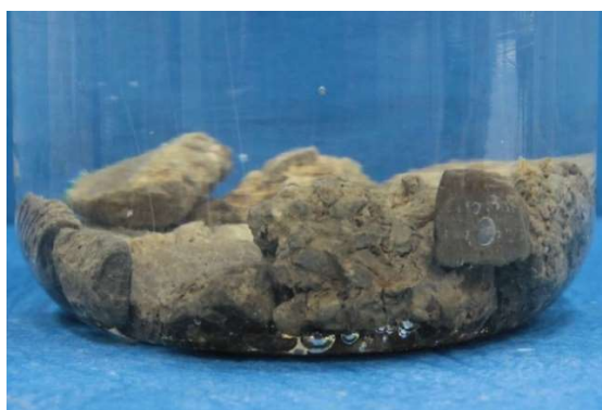
Fot. nr 51a. Próbka tuż po dodaniu roztworu NaCl.
