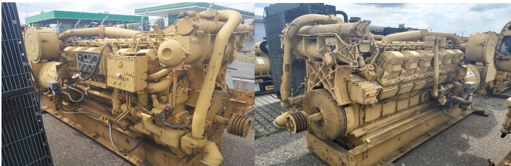
8. 323000388 SILNIK SPALINOWY CAT D398
