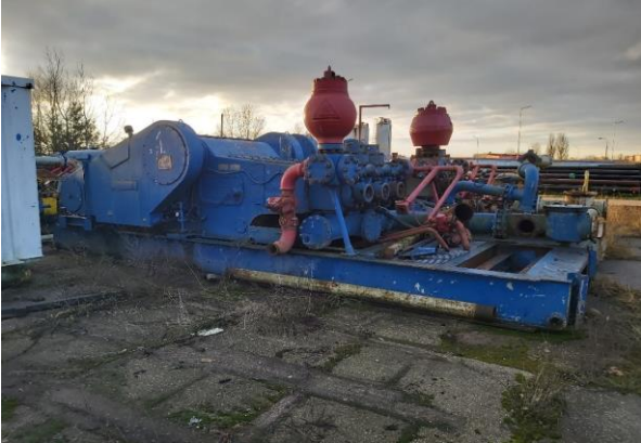
15. POMPA PŁUCZKOWA 5100039192 Piła
